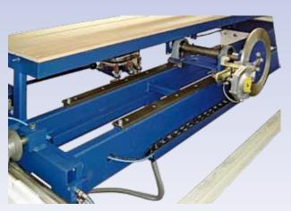
3D-Werkstück-Handlingvorrichtung über Führungen von der Tischmitte zur rechten Tischseite verschiebbar.
