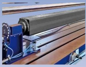
Werkstückspann- und Drehvorrichtung auf dem Maschinentisch montiert, pneumatisch bestätigt.
