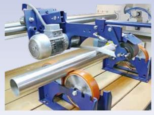
Rohrschleifaggregat bestehend aus dem Querschleifaggregat, einem angetriebenen Rollenbock und einem Rollenbock als Mitläufer.
