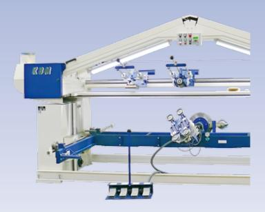
M2S97 mit 3D-Werkstück-Handlingvorrichtung (Mehrpreis) im U-Tischrahmen eingebaut. Die Entriegelung der Drehund Schwenkachsen erfolgt pneumatisch über Fußschalter. Die Bewegung der Achsen erfolgt manuell. Auf Wunsch ist die Maschine mit einem zweiten Schleifschuh-Aggregat lieferbar.
