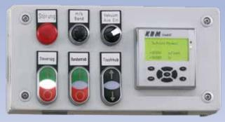
Bedienpult mit den Hauptfunktionen in der Maschinenmitte angeordnet. Display zur Anzeige der eingestellten Bandgeschwindigkeit und Fehlermeldungen.
