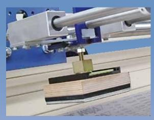
Schleifschuh mit Kugelschnellklemmung.
