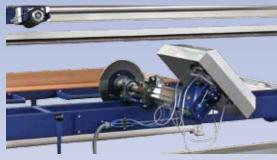
Das Werkstück ist über vier Vakuumsauger gespannt. Max. Werkstückgewicht an der 3D-Werkstückhandlingvorrichtung bezogen auf die Aufspannplatte = 50 daN bzw. 220 Nm bezogen auf die Drehachsenmitte.
