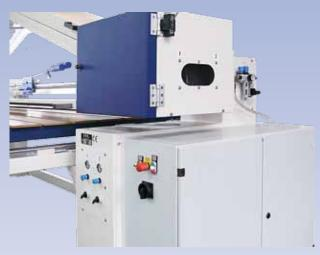
Rechter Maschinenständer mit Kröpfung, Schalter und Druckregler für pneumatische Bandspannung. Von vorn bedienbar.
