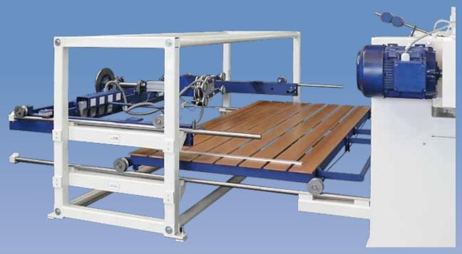
Zweiter Maschinentisch mit 3D-Werkstückhandlingvorrichtung und Lagergestell (Mehrpreis) hinter der Maschine aufgestellt zum Wechseln der Maschinentische.
